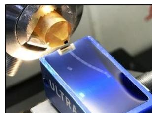
**エッチング**：カーボン薄膜、有機材料などの表面をナノオーダーでエッチングしたい時に活用可能。
