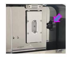
割断ハンドルを時計回りに回すと割断ニードルが出てきます。ニードルがアンプルに押し当てられ、 テコの原理で割断されます。ガラスが割れた感触を感じるまで回してください。
